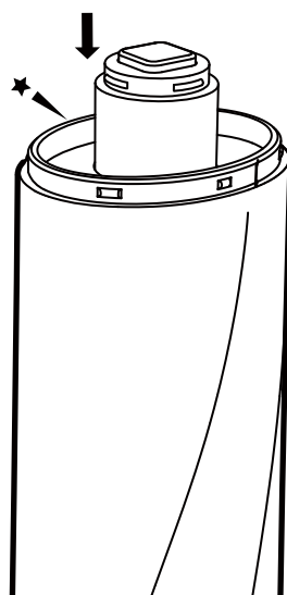
3.将精华液瓶向下垂直插入安装槽中，听到轻微的卡紧声，确保其安装到位
